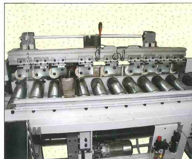
Führung- und Gegendruckrollen bei der Leimangabestation.
