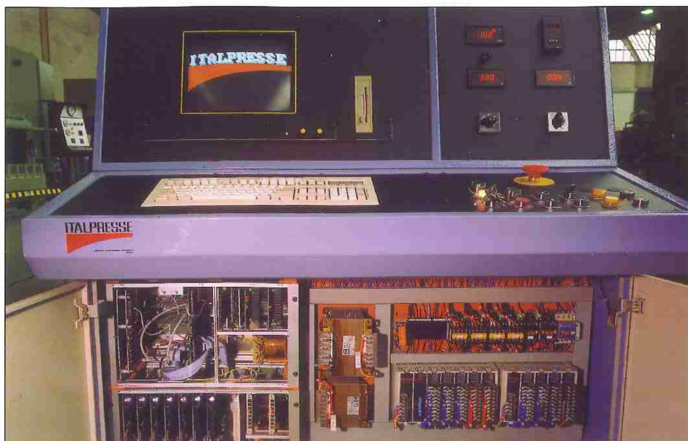
Particolare dei nostri quadri elettronici a logica comandata da P.L.C. e gestita da P.C. PLC and PC control board. Détail des nos pupitres électroniques à logique commandée par P.L.C. et gerée par P.C. Detail unserer Schaltschränke mit P.C. Steuerung und P.L.C. Speicher.
